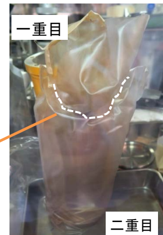
② 破裂後の一重目と二重目の袋の状態
