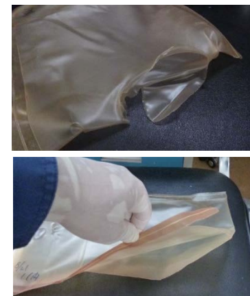
図2 試験後の樹脂製の袋の写真 (上図:二重目, 下図:一重目)
